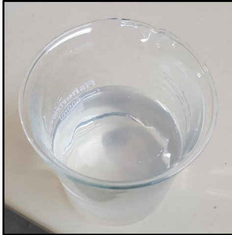
Figure 61 : Échantillon de 0.5 L d'une solution de Xanthan Gum food grade XGF FNCS de concentration 9000 ppm.
