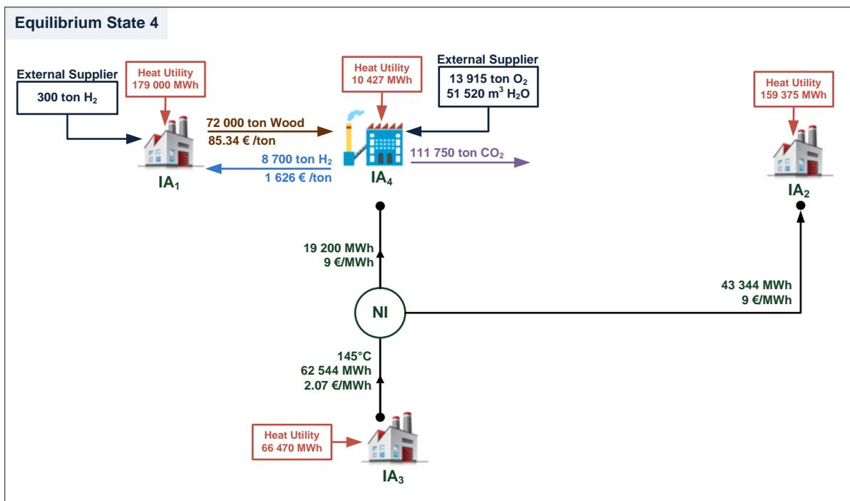
Fig. 15. Configuration de l'éco-parc pour l'état d'équilibre le plus adéquat du schéma non-coopératif
