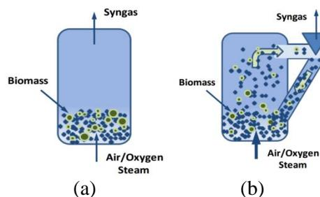
Figure 3.6. Fluidized bed gasifier:
