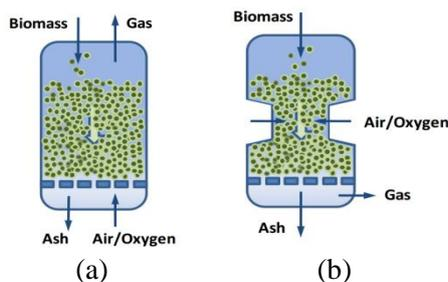
Figure 3.5. Fixed bed gasifier:
