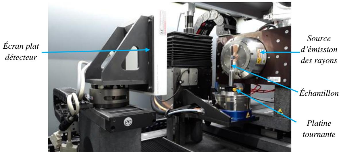
Figure II. 2 : tomographe à Rayons X
