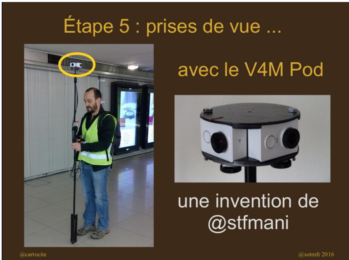
Figure 4.6. Le V4M Pod, dispositif de prises de vue à 360° conçu et construit par Nicolas, employé de Carto'Cité. Source : diaporama de Carto'Cité disponible à l'adresse : https://www.slideshare.net/winerflo/cartographie-des-gares-de-paris-sncf-transilien-cartocit consulté le 23 juillet 2019.
