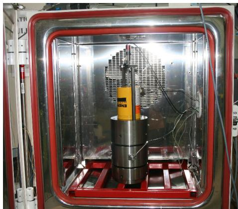
FIGURE I.12 – La cellule triaxiale à l'intérieur de l'enceinte climatique.
