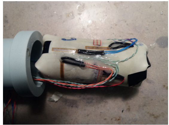
FIGURE I.13 – Dispositifs de mesure de température et de déformation locale.
