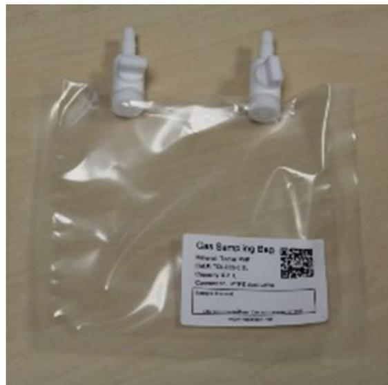
Figure 4.39. Photographie d'un sac Tedlar deux voies de 200 ml
