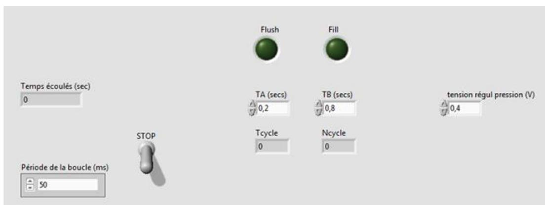
Figure 3.14. Tableau de bord du programme labView utilisé pour contrôler les paramètres du modulateur
