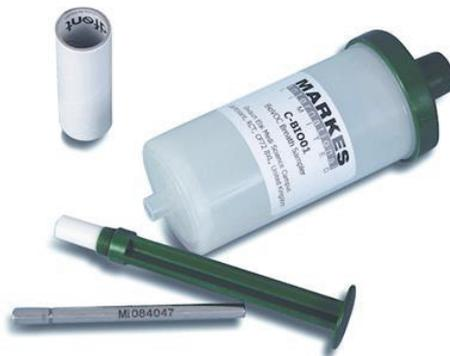
Figure 1.9. Photographie du système BIO-VOC
