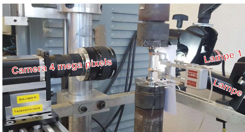
Figure 6 : Montage expérimental pour les essais quasi-statiques sur éprouvettes AE à la température ambiante
