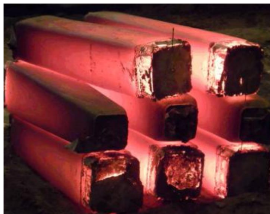
Figure II.1 : Lingots sur le parc à lingots juste après démoulage, d'après Dumerger et al. 2013 [2]
