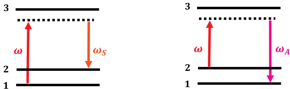
Figure 3.8 : Diagramme des niveaux d'énergie qui illustre la diffusion Raman Stokes et anti-Stokes.
