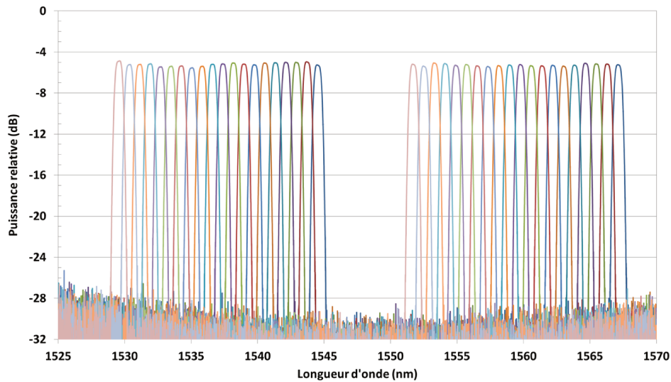
FIGURE 3.22 – Profil de longueur d'onde des AWG utilisés dans le prototype mesuré à l'analyseur de spectre optique avec une résolution de 2pm
