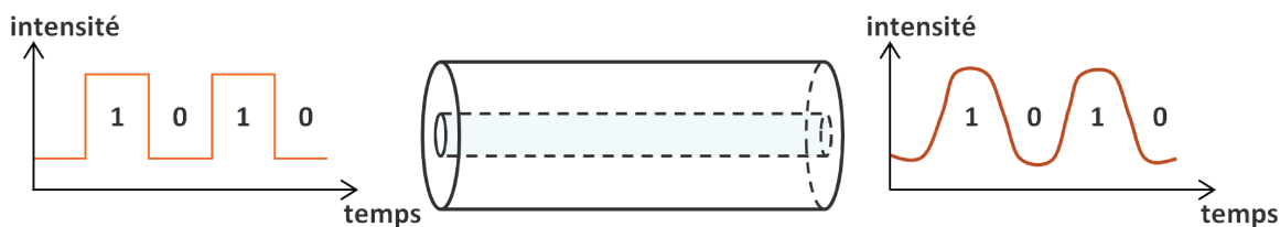
FIGURE 1.2 – Représentation de la dispersion chromatique sur les données après propagation dans la fibre optique
