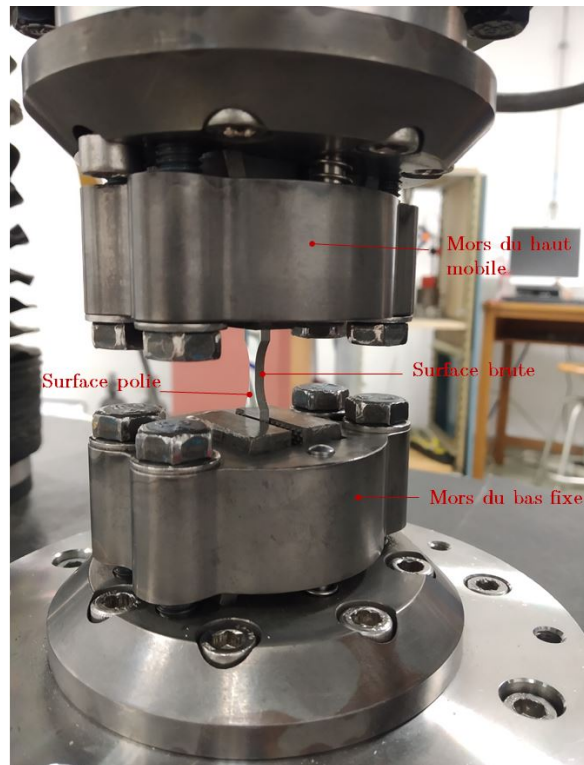
FIGURE 3.17 – Photographie du dispositif d'essai de traction à R=0.1 sur éprouvette plate SLM SB
