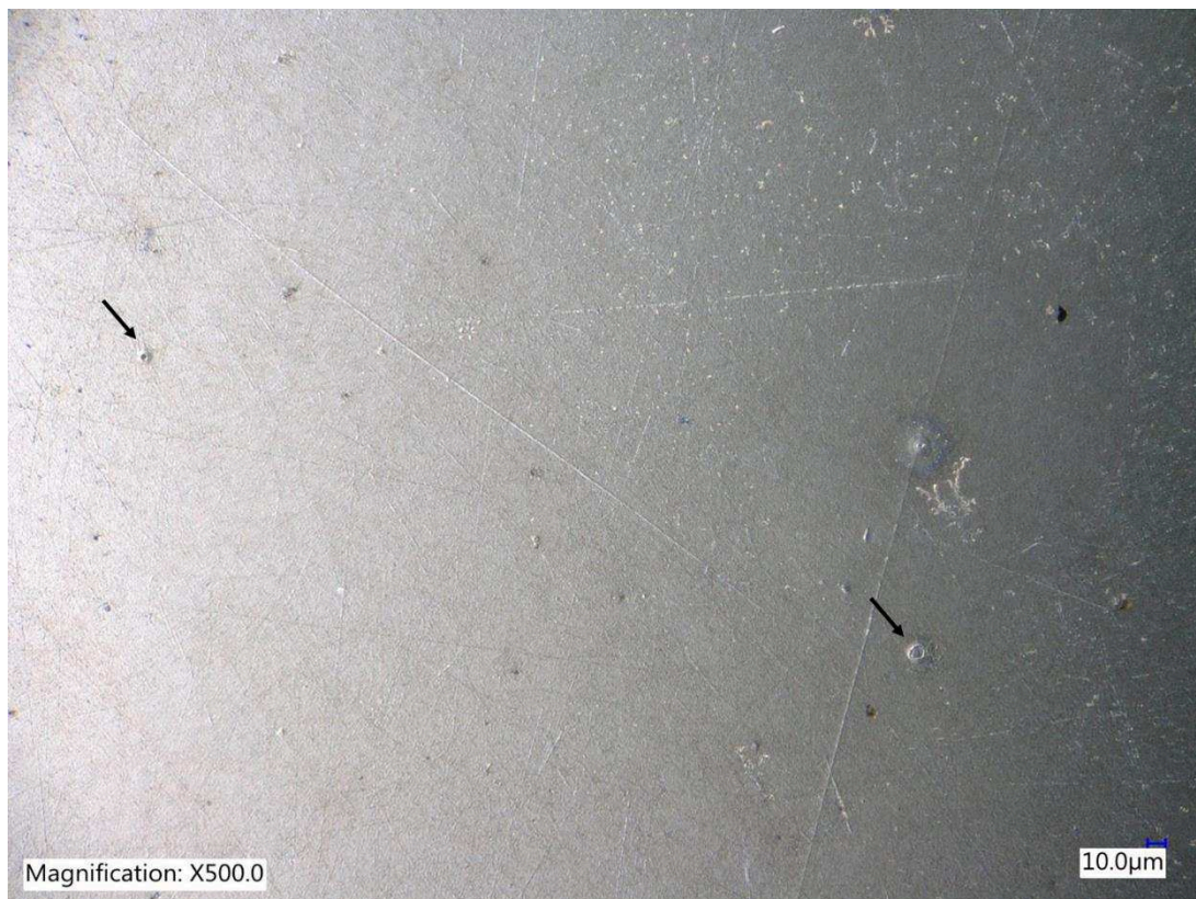
Figure VI-2 : Image obtenue au microscope optique avec un grossissement de 500 d'un échantillon d'aluminium pur après 13h dans une solution à 0,1M de NaCl. Les flèches noires indiquent des piqûres repassivées ou en cours de repassivation (apparition du dôme blanc de \text{Al}(\text{OH})_3 ).
