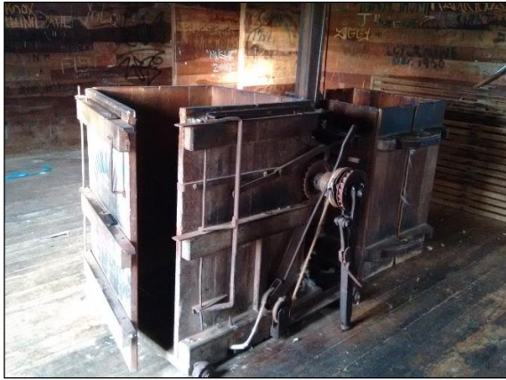
Figure 79 : Presse à laine. Photographie prise par M. Hugonnet (septembre 2015).
