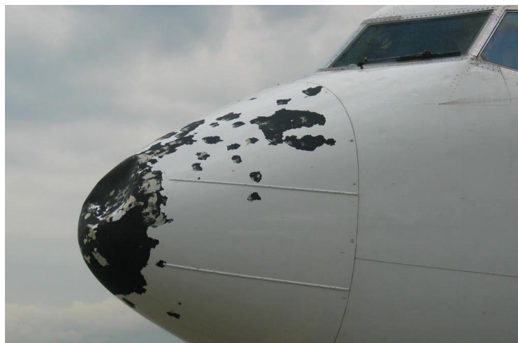
Figure I-1 : Nez d'aéronef fortement endommagé par une précipitation de grêle (Field et al. 2009)
