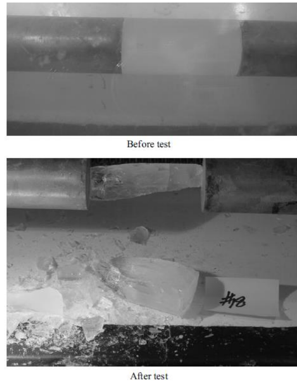
Figure 2-32 : Echantillon de glace avant et après rupture aux barres de Hopkinson (K. Dutta et al. 2004)
