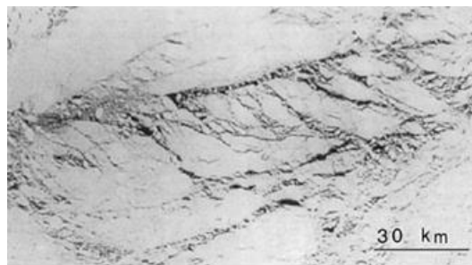
Figure 2-14 : Observations de ruptures en cisaillement similaires a) petite échelle et b) grande échelle (E.M. Schulson 2001)
