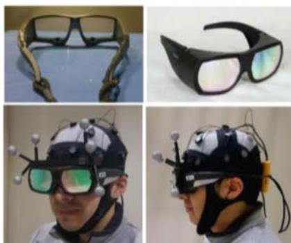
Figure 4: Lunettes oculométriques SMI (en haut à gauche), adaptées aux lunettes Infitec (en haut à droite) à utiliser dans l'environnement CAVE. Chaque participant devra porter ces deux lunettes et une coiffe ECG (photos du bas) au cours de l'expérience.
