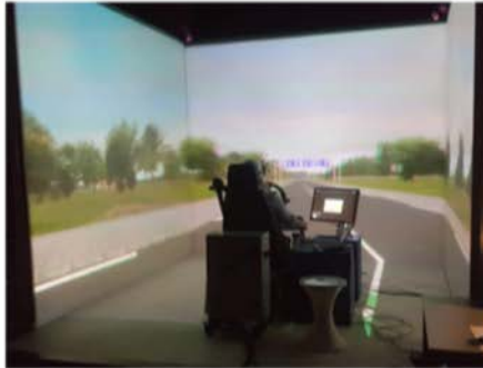
Figure 6: Le système CAVE et le simulateur de conduite SI2M
