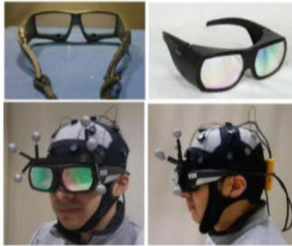
Figure 4: Lunettes oculométriques SMI (en haut à gauche), adaptées aux lunettes Infitec (en haut à droite) à utiliser dans l'environnement CAVE. Chaque participant devra porter ces deux lunettes et une coiffe ECG (photos du bas) au cours de l'expérience.
