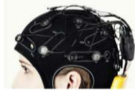
Figure 3: Coiffe en néoprène munie d'électrodes posée sur la tête d'un sujet
