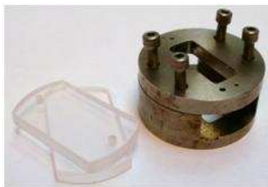
Figure 19. Cellule chauffante et pastilles KBr pour l'analyse IR en temps réel de la réticulation de la matrice époxy.
