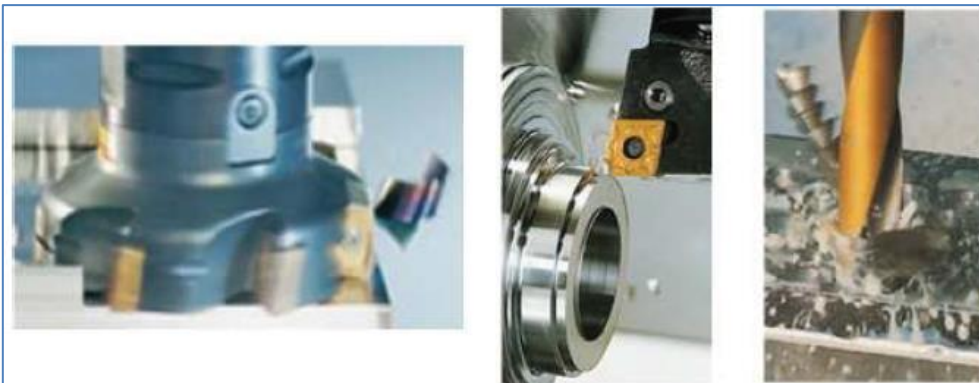
Figure I-1 : Illustrations des principaux procédés d'usinage par outils coupants (Crédit Photo : Sandvik-Coromant).
