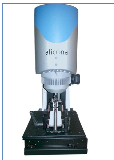
Figure III-14 : Système de mesure tridimensionnelle des outils
