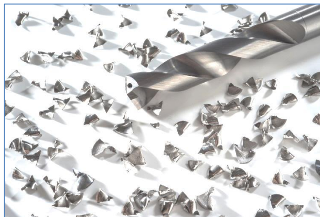
Figure I-27 : Copeaux de titane obtenus en PAV (Lonfrier & de Castelbajac 2014)
