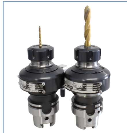
Figure III-2 : Porte-Outils à assistance vibratoire employés dans le cadre des essais.
