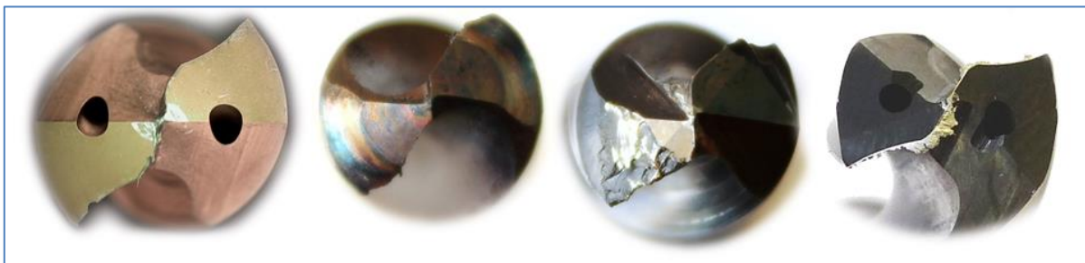
Figure I-61 : Différents modes d'endommagement des outils en perçage.
