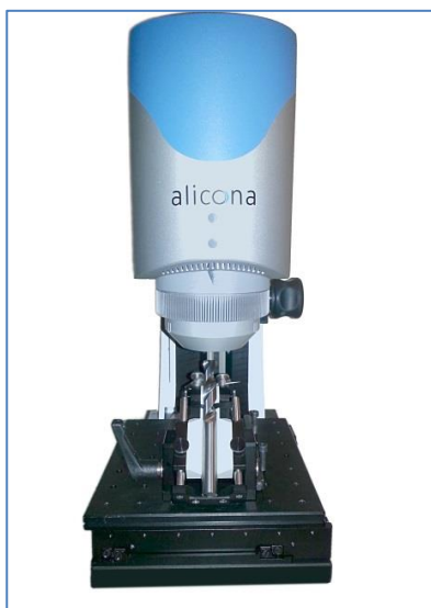
Figure III-14 : Système de mesure tridimensionnelle des outils
