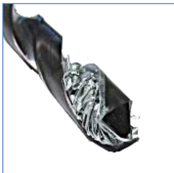
Figure I-17 : Collage des copeaux dans les goujures de l'outil (Bondarenko 2010).
