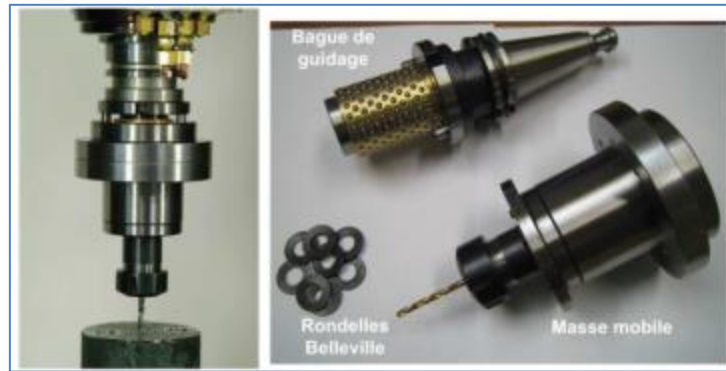
Figure I-29 : Porte-outil pour le perçage vibratoire auto-entretenu (Guibert et al. 2008).
