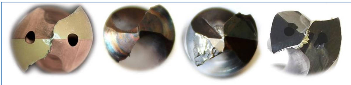
Figure I-61 : Différents modes d'endommagement des outils en perçage.
