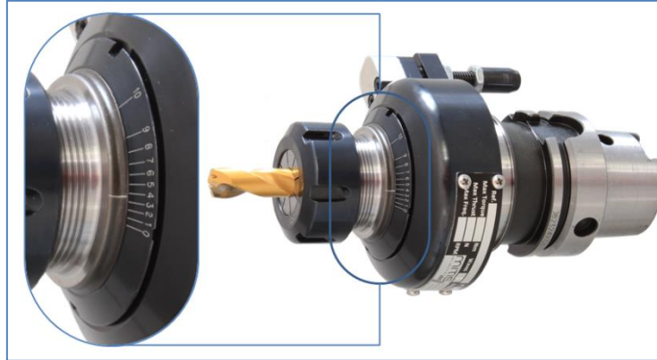
Figure II-13 : Régler de l'amplitude sur le dispositif d'assistance par vibrations.
