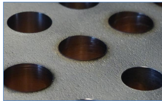
Figure I-18 : Brûlures de la pièce en perçage.
