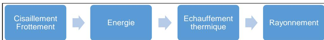
Figure 99 – Origine du rayonnement thermique lors d'une opération d'usinage.
