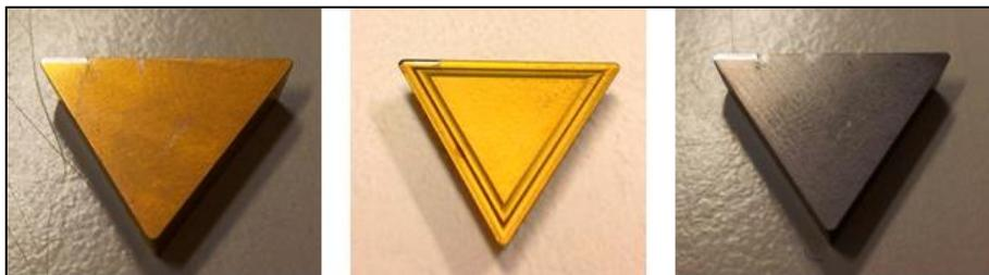
**Figure 53 – Plaquettes TPUN, TPMR et TPGN retenues pour les essais.**
