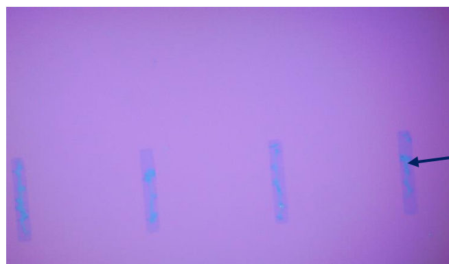
Figure 39. Mise en évidence de la non adhérence de l'alumine au graphène. On voit qu'après le lift-off, les 3nm d'aluminium oxydé s'enlève en partie et expose le graphène à la résine et au développeur qu'on utilisera à la prochaine lithographie
