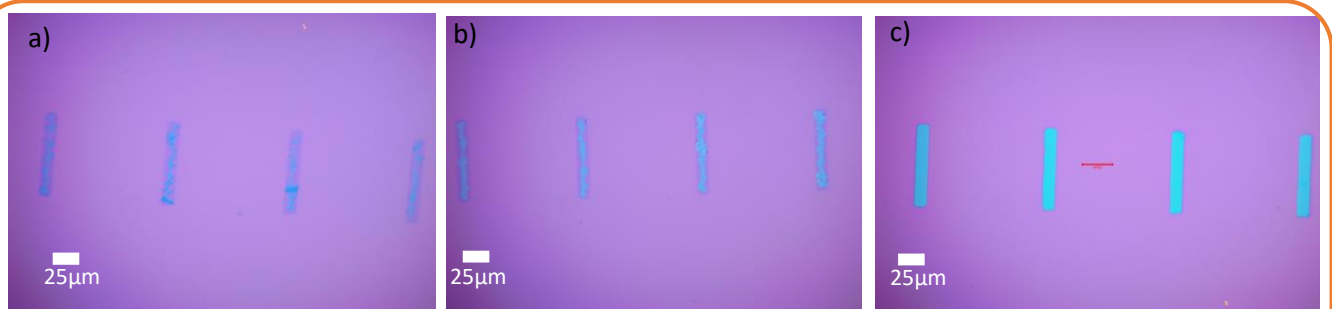
Figure 36 Protection du graphène lors des procédés de lithographie. a) Protection avec 3nm d' \text{AlO}_x , b) Protection avec 15nm de \text{Al}_2\text{O}_3 (ALD), c) Protection avec 3nm \text{AlO}_x et 15nm \text{Al}_2\text{O}_3 (ALD)
