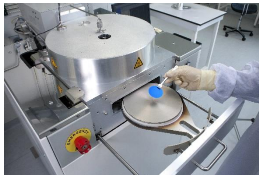
Figure 43 Photographie du bâti de dépôt de SiO x par PECVD de Paris7
