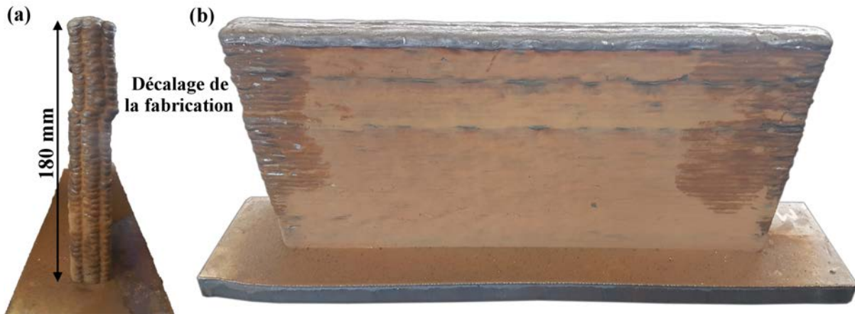
FIGURE 78 – Photos du mur présentant un décalage de fabrication à cause d'un pivotement de la torche : (a) de côté et (b) de face.
