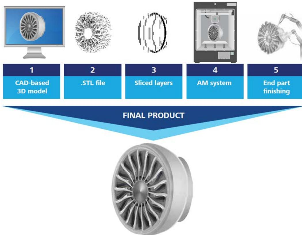
FIGURE 2 – Illustration des étapes de la fabrication additive [5].
