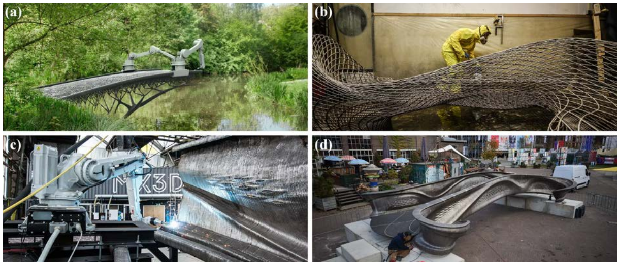
FIGURE 11 – Evolution des développements de MX3D : (a) idée initiale, (b) stratégie de fabrication en treillis point par point, (c) stratégie de fabrication par cordons et (d) la passerelle piétonne terminée 1 .
