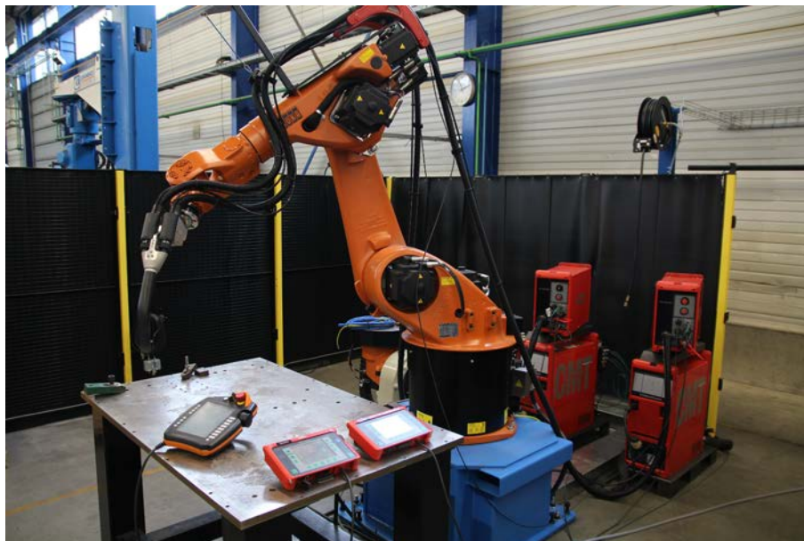
FIGURE 30 – Cellule robot et générateur TPS4000 utilisés pour la fabrication.
