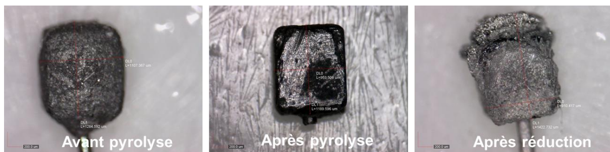
Figure IV-58 : Photographies des diélectriques avant pyrolyse (gauche) après pyrolyse (centre) et après réduction (droite).
