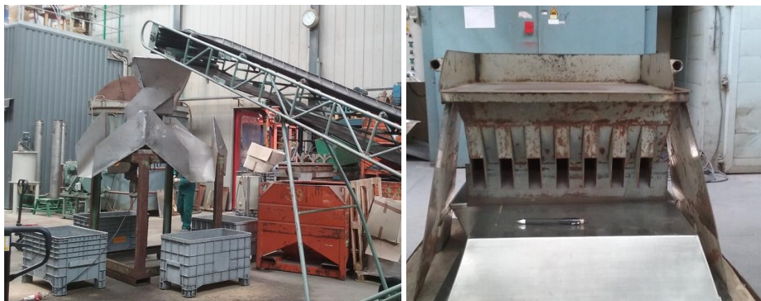
Figure 20: Diviseur à carrousel (gauche) et diviseur à riffles (droite) avec ouvertures de 30 mm utilisés dans cette étude pour les divisions de matière.
