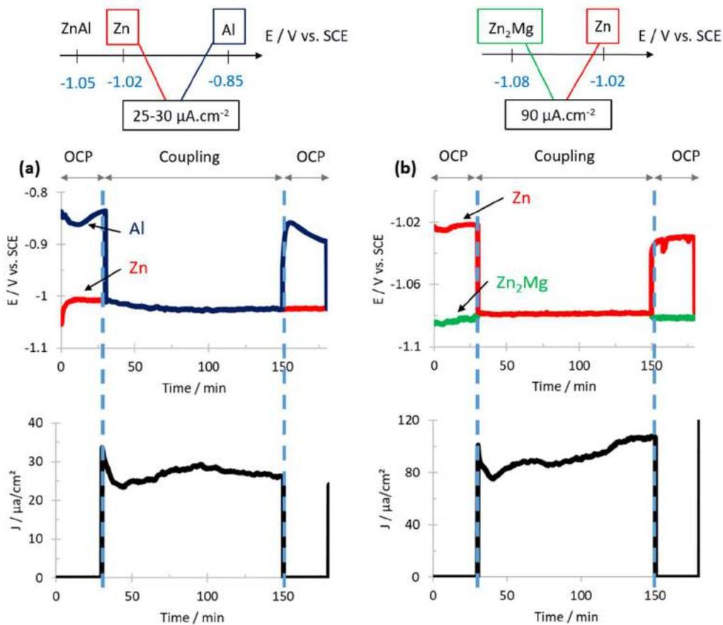
Figure 11: Evolution du potentiel et de la densité de courant de (a) Zn/Al et (b) Zn/Zn<sub>2</sub>Mg après 30 min d'immersion puis 2 h de couplage dans Na<sub>2</sub>SO<sub>4</sub> 5 wt. % pH 2,6 à 25 °C
