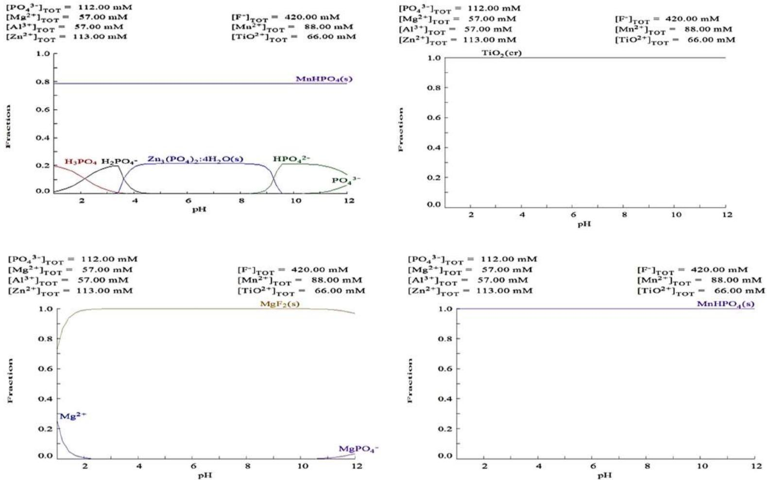
Figure 56: Predominant equilibrium species for 113 mM Zn<sup>2+</sup> + 57 mM Al<sup>3+</sup> + 57 mM Mg<sup>2+</sup> + 112 mM PO<sub>4</sub><sup>3-</sup> + 66 mM Ti<sup>4+</sup> + 88 mM Mn<sup>2+</sup> + 420 mM F<sup>-</sup> using the Hydra-Medusa software and associated database of equilibrium constants at 25 °C
