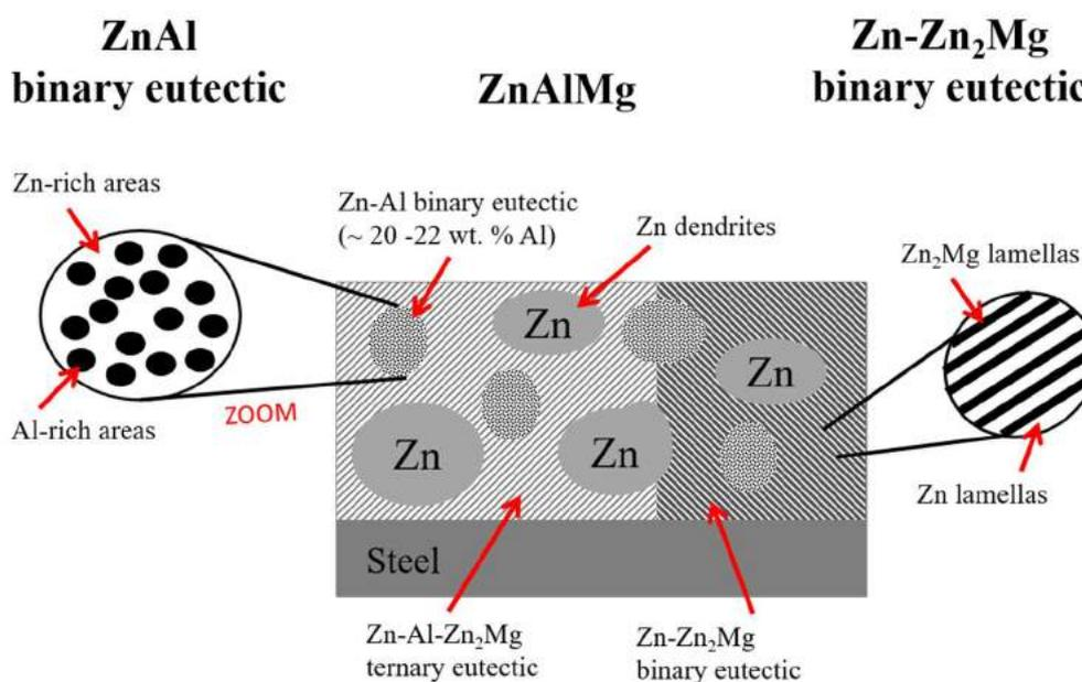
Figure 1: Schéma de la coupe d'un revêtement ZnAlMg. Le binaire Zn- $Zn_2Mg$  est composé de lamelles de Zn (claires) et de lamelles de  $Zn_2Mg$  (foncées) tandis que le ternaire comprend Zn,  $Zn_2Mg$  et une fine phase d'Al. Le binaire ZnAl est composé de zones riches en Zn (claires) et zones riches en Al (foncées)
