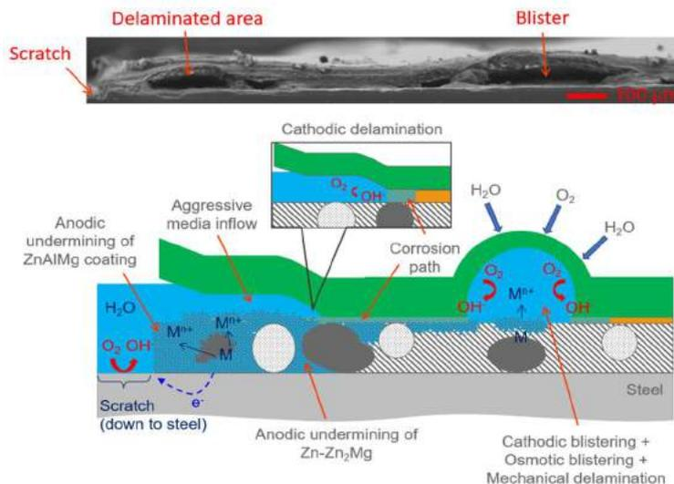
Figure 17: Schéma du mécanisme de dégradation des revêtements ZnAlMg peints en présence d'un défaut à l'acier
