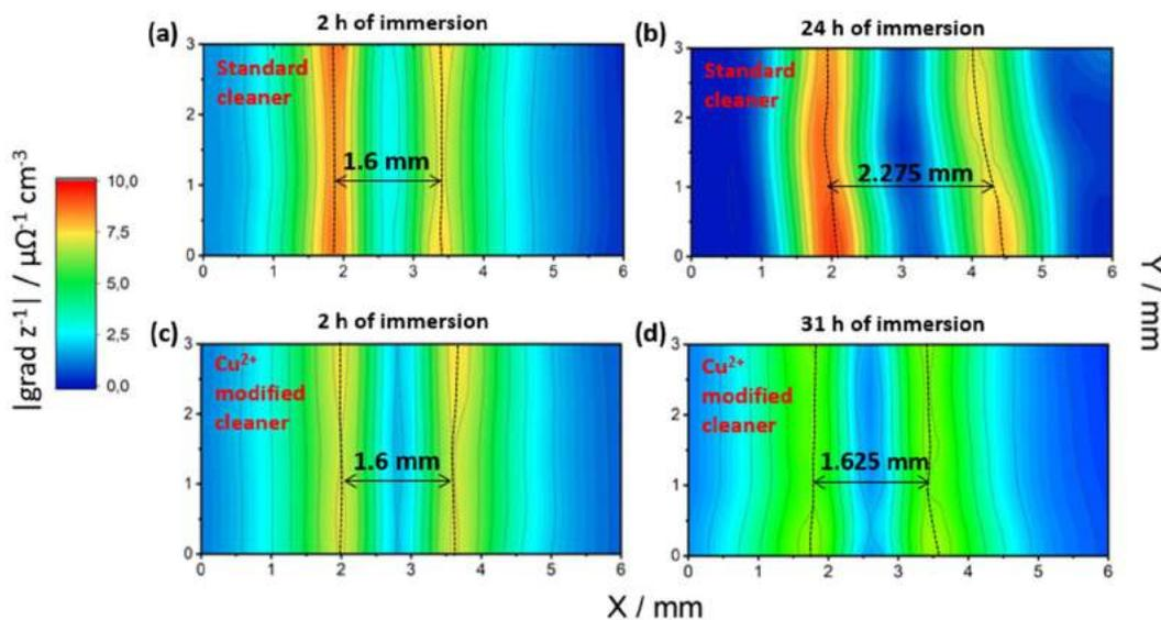
Figure 13: Gradient du module d'admittance de ZnAlMg revêtu de polymère modèle sur le TiCC après dégraissage alcalin standard: (a) après 2 h d'immersion, (b) après 24 h d'immersion et pour ZnAlMg traité avec le dégraissant aux ions Cu<sup>2+</sup>: (c) après 2 h d'immersion, (d) après 31 h d'immersion
