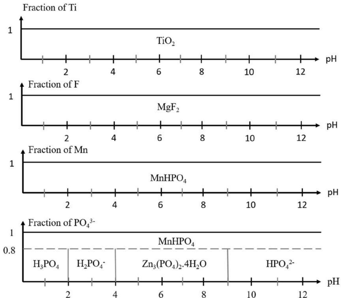
Figure 37: Predominant equilibrium species for 113 mM Zn<sup>2+</sup> + 57 mM Al<sup>3+</sup> + 57 mM Mg<sup>2+</sup> + 112 mM PO<sub>4</sub><sup>3-</sup> + 66 mM Ti<sup>4+</sup> + 88 mM Mn<sup>2+</sup> + 420 mM F<sup>-</sup> using the Hydra-Medusa software and associated database of
