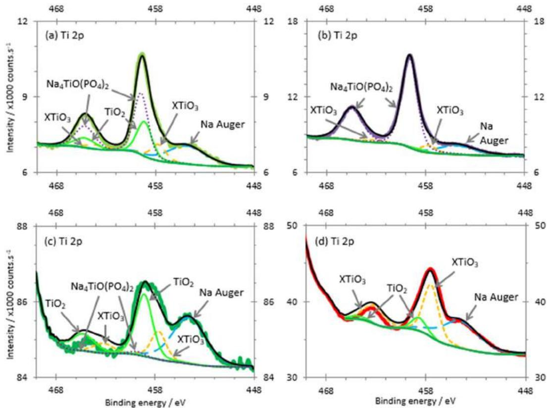
Figure 8: Spectre XPS Ti 2p et déconvolution : (a) activateur à l'état initial, (b) activateur après dissolution et évaporation du solvant, (c) Zn<sub>2</sub>Mg et (d) Zn
