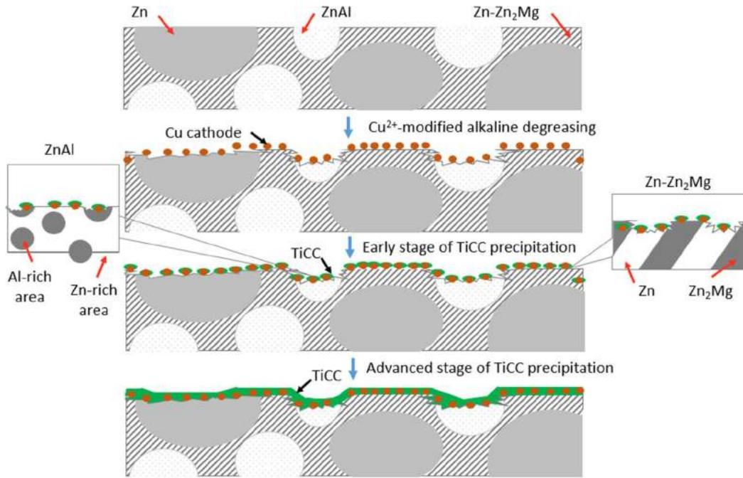
Figure 16: Schéma du mécanisme de précipitation de TiCC sur ZnAlMg après dégraissage alcalin contenant des ions Cu<sup>2+</sup>
