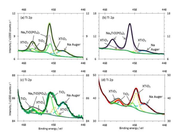
Figure 8: Spectre XPS Ti 2p et déconvolution : (a) activateur à l'état initial, (b) activateur après dissolution et évaporation du solvant, (c) Zn2Mg et (d) Zn
