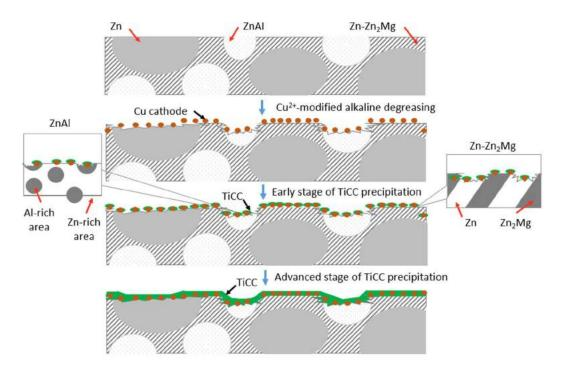
Figure 16: Schéma du mécanisme de précipitation de TiCC sur ZnAlMg après dégraissage alcalin contenant des ions Cu2+
