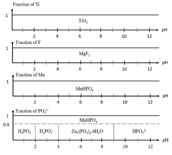
Figure 37: Predominant equilibrium species for 113 mM Zn<sup>2+</sup> + 57 mM Al<sup>3+</sup> + 57 mM Mg<sup>2+</sup> + 112 mM PO<sub>4</sub><sup>3-</sup> + 66 mM Ti<sup>4+</sup> + 88 mM Mn<sup>2+</sup> + 420 mM F<sup>-</sup> using the Hydra-Medusa software and associated database of
