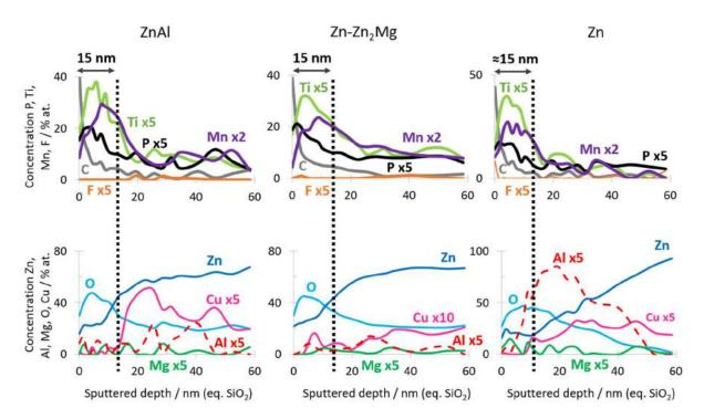
Figure 12: Profils d'érosion par spectroscopie auger des phases de ZnAlMg après immersion dans le bain de TiCC à 60 °C pendant 30 sec après un dégraissage alcalin contenant des ions Cu2+
