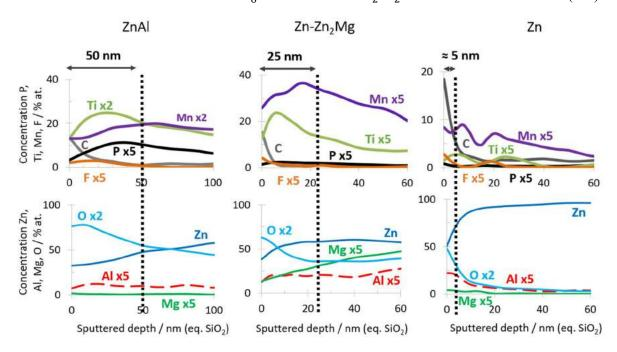
Figure 10: Profils d'érosion par spectroscopie auger des phases de ZnAlMg après immersion dans le bain de TiCC à 60 °C pendant 30 sec après un dégraissage alcalin
