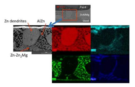
Figure 6: Cartographie MEB-EDS d'un revêtement ZnAlMg peint après 72 heures de chronopotentiométrie à 5 μA dans une solution de NaCl 1 wt. % pH 7
