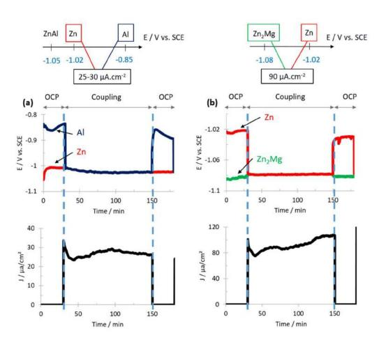
Figure 11: Evolution du potential et de la densité de courant de (a) Zn/Al et (b) Zn/Zn2Mg après 30 min d'immersion puis 2 h de couplage dans Na2SO4 5 wt. % pH 2,6 à 25 °C
