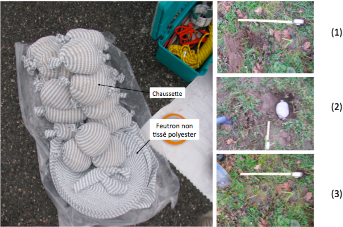
Figure 3.15- Dispositifs à granulométrie contrôlée appelés « chaussettes » conçus pour être enterrés en subsurface dans l’objectif de pouvoir mesurer l’évolution temporelle de la composition isotopique de l’infiltration. (1-2-3) étapes d’installation des « chaussettes » en subsurface.
