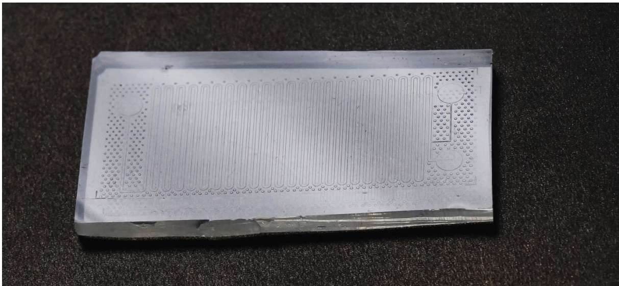
Figure 2.2.5 : Moule négatif du canal en PDMS
