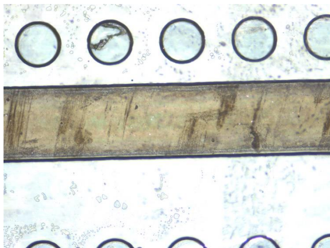
Figure 5.4.8 : Photo du dépôt au fond d'un réacteur après passage de benzène sous plasma d'oxygène. Le dépôt est de couleur brune ; cependant, il est possible de distinguer des stries, provenant de NOA résiduelle au fond du canal déposée lors de la fabrication. Cette NOA résiduelle est plus foncée : le dépôt est plus important à cet endroit.
