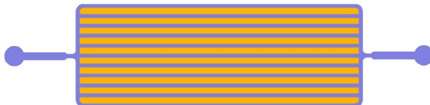
Figure 2.2.12 : Exemple d'un réacteur impossible à construire par cette méthode. En effet, la zone en orange n'est pas accessible par une capillarité sur les bords : les zones en bleus sont des murs infranchissables.
