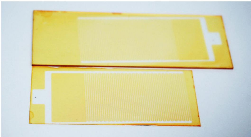
Figure 2.2.4 : Lame et lamelle couverte d'une résine S1818 avec un motif micrométrique, qui permettra ensuite le dépôt localisé d'électrode.
