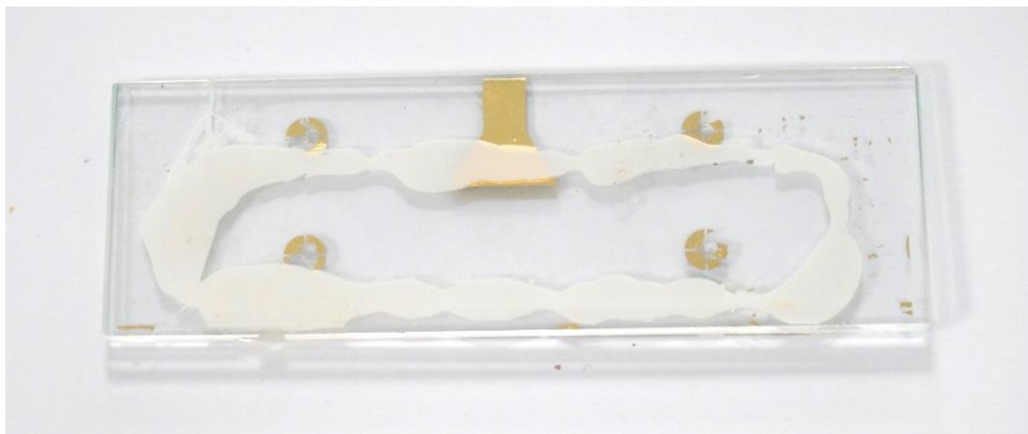
Figure 2.3.19 : Premier essai de réacteur au silicone. Ce réacteur, étanche, a servi à générer un plasma dans une zone sans contact avec la NOA. Elle a permis également par la suite d'avoir une enceinte de confinement avec un catalyseur déposé.
