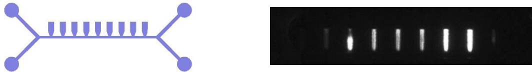
Figure 2.3.2 : Réacteur à cavités. A gauche, masque sur Clewin ; à droite, l'émission par un plasma enregistré par caméra ICCD. Le gaz, et donc le plasma si situe uniquement dans les cavités, remplies préalablement, puis un écoulement de liquide est installé.
