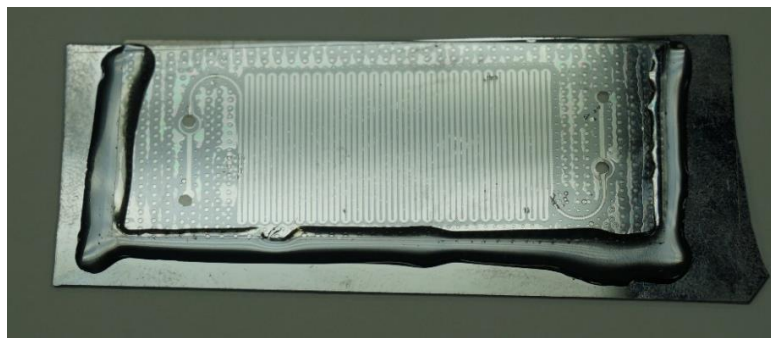
Figure 2.3.22 : réacteur fabriqué avec un Wafer de silicium en remplacement de la lame de verre. La lamelle a ensuite été également remplacée, mais la transparence n'était plus assurée. Ce type de réacteur n'est pas fonctionnel pour générer un plasma.
