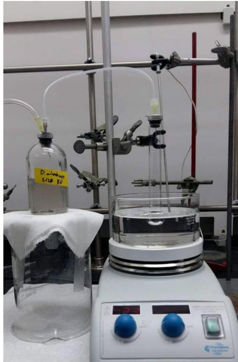
Figure II-13: Système de sulfuration par voie bactérienne en utilisant le gaz  $H_2S$  produit par les BSR
