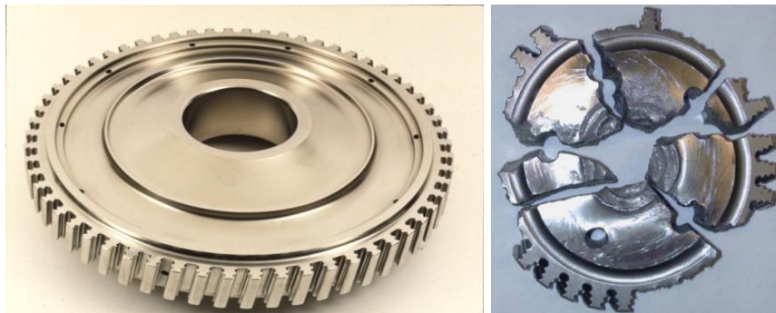
Figure 1-2 : (a) Photographie d'un disque de turbine neuf et (b) d'un disque après éclatement sur un banc d'essai (cours : [MMS, 2014])
