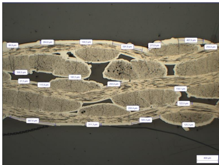
Figure II.18 - Composite C/SiC dans son sens longitudinal après essai de traction avec mesures de distances entre deux fissures
