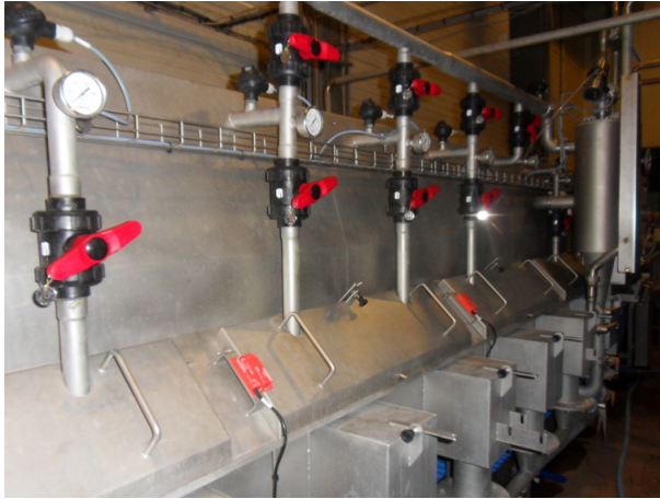
FIGURE 4.13 – Photo : blancheur de face, 1 zone de pré-chauffage, 4 zones de blanchiment
