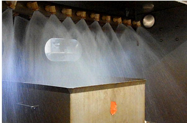
FIGURE 2.13 – Photo des buses d'aspersation en fonctionnement sur le banc d'essai
