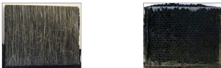
(a) Rupture dans le composite (cohésive) (b) Rupture à l'interface (adhésive)
