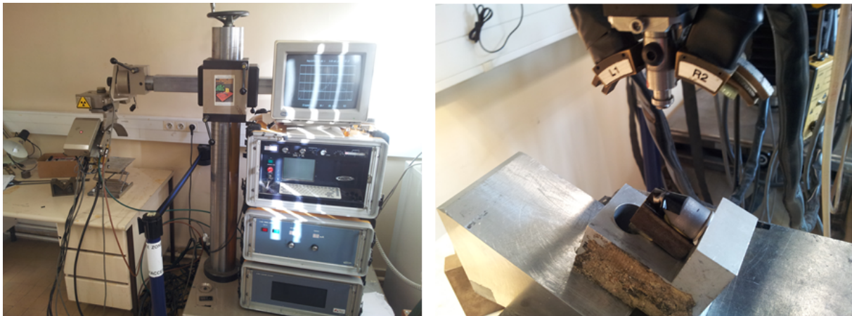
FIGURE 3.55 – Équipement PROTO iXRD de l'ENSAM Paris, la photographie à droite met en évidence les deux capteurs
