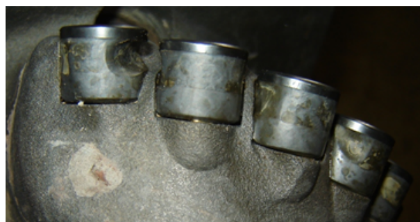
FIGURE 4.7 – Taillants dont certains supports en carbure cémenté ont subi de l’érosion (Source : Varel)
