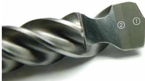
FIGURE 2.2 – Mèche à tête monobloc graduée commercialisée par HILTI; la couche 1 présente une bonne résistance à l'usure et la couche 2 est tenace et permet un assemblage par soudure stable sur le corps en acier (source : magazine impact de janvier 2008) d'après [Sorlier, 2009]
