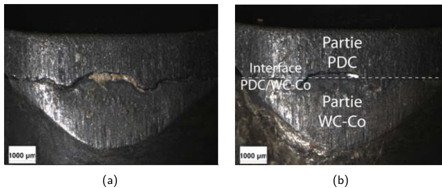
FIGURE 4.69 – Faciès d'usure des taillants de type "Titan 2" (a) et "Titan G2" (b) d'après [Yahiaoui, 2013]
