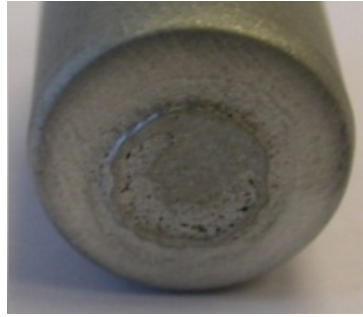
FIGURE 3.20 – Photographie de la surface d'imbibition d'un insert traité par imbibition avec un cru Co65 de masse 1g
