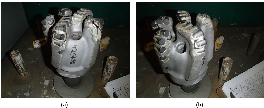
FIGURE 4.75 – Photographie d'outil après essai chantier, les taillants gradués sont désignés par une marque noire
