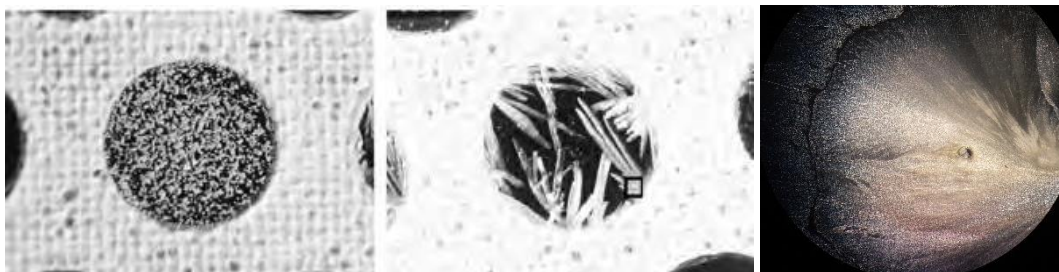
Figure 21 : Comparaison visuelle de la forme des cristaux formés par différentes matrices MALDI. (gauche) CHCA, cristaux rhomboédrique, (milieu) DHB, cristaux en aiguilles, (droite) 3-AQ/pCA, matrice formant un gel à pression atmosphérique. (Photos CHCA et DHB issues de la publication de Helen M Karlsson et al. « Two-Dimensional Gel Electrophoresis and Mass Spectrometry in Studies of Nanoparticle-Protein Interactions »)
