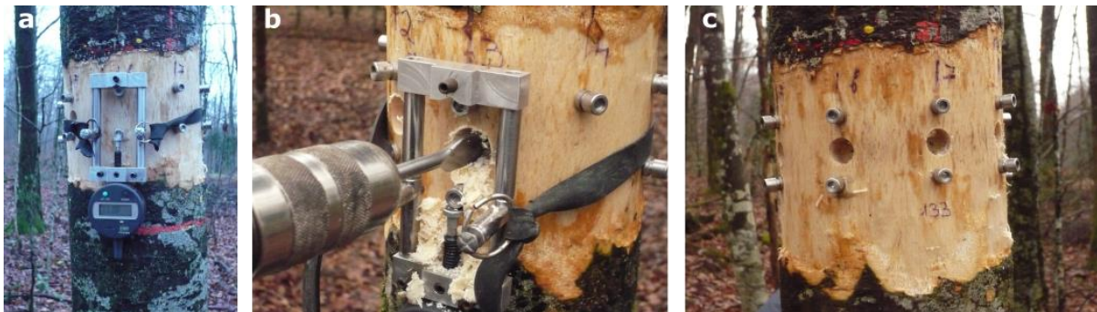
Figure 4.1 : Mesures des ICC par la méthode du trou unique.
