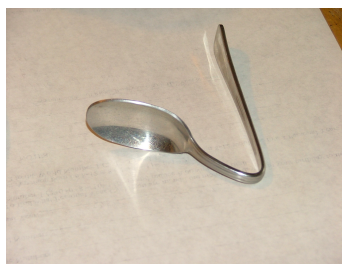
FIGURE 1.4 – Déformation plastique d’une cuillère métallique 1
