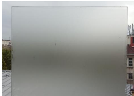
Figure 147. Photo d'un film de HEA (2 mol% réticulant, 1 mol% amorceur, épaisseur 20 µm) obtenu dans un convoyeur UV à 2 m/min et 600 mW/cm 2 .
