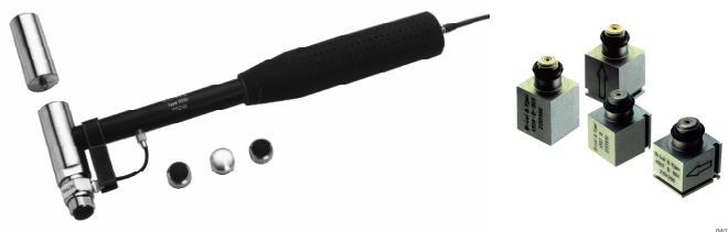
FIGURE 5.2 – Matériel pour l'analyse modale : marteau BK-8202 et les accéléromètres BK-4507
