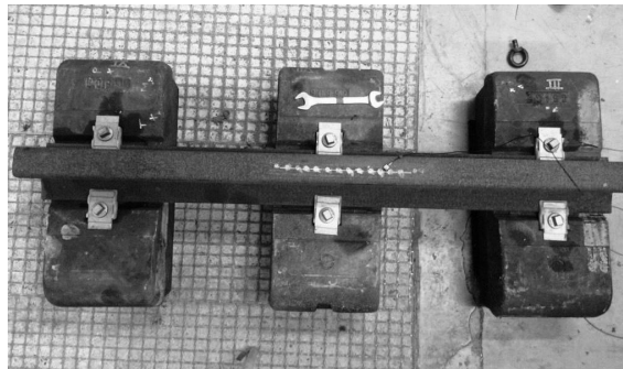
FIGURE 5.31 – Voie assemblée au laboratoire
