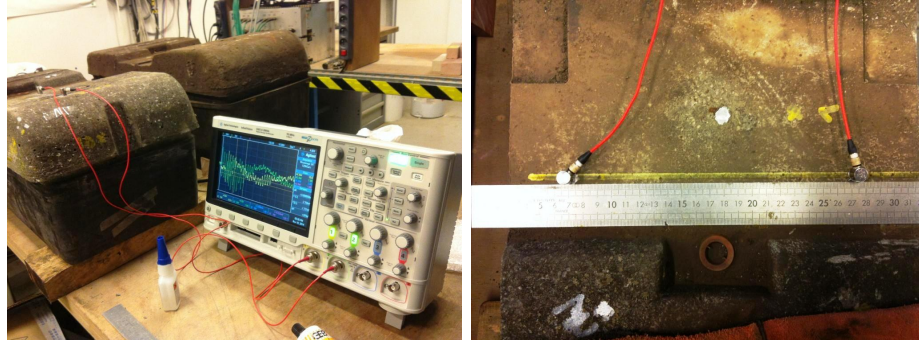
FIGURE 4.15 – Matériels pour la méthode d'émission acoustique
