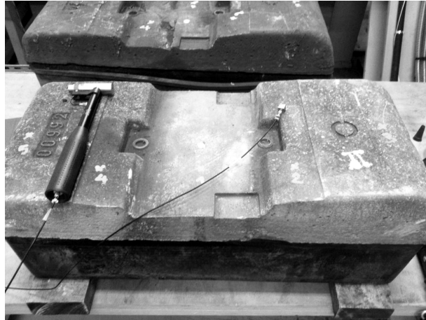
FIGURE 5.3 – Dispositif de mesure modale d'un blochet en condition libre
