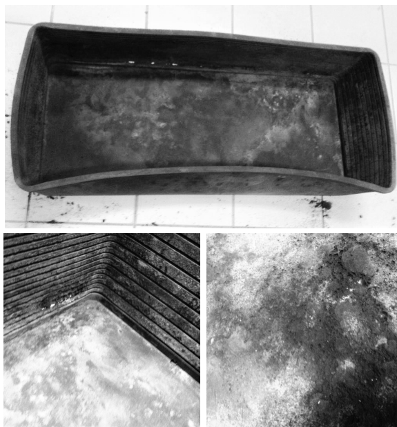
FIGURE 4.3 – Chausson dégradé (en haut) avec vue intérieure (à gauche) et vue extérieure (à droite)
