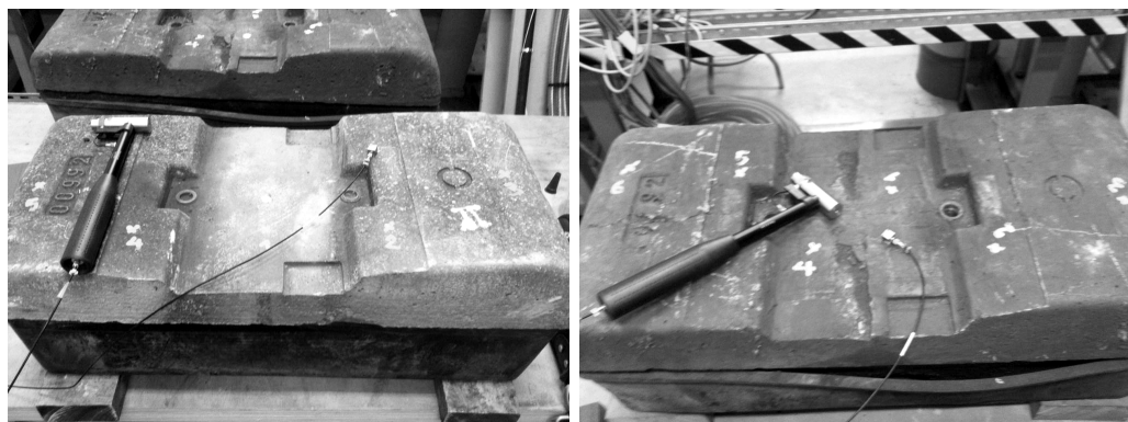
FIGURE 5.6 – Blochet neuf (à gauche) et blochet dégradé (à droite)
