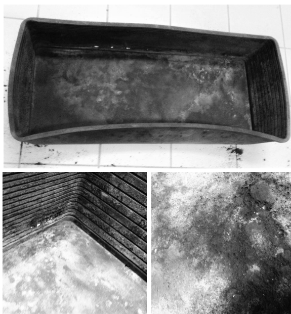
FIGURE 4.3 – Chausson dégradé (en haut) avec vue intérieure (à gauche) et vue extérieure (à droite)
