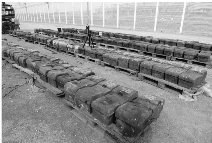
FIGURE 5.26 – Mesure des modes propres des blochets usés en condition libre
