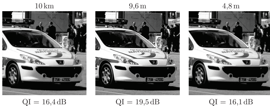
FIGURE 3.27 – Simulation des images données par la caméra hybride avec le masque de phase pyramidal et le noyau de déconvolution tronqué dans l'espace direct sur 11 \times 11 pixels.
