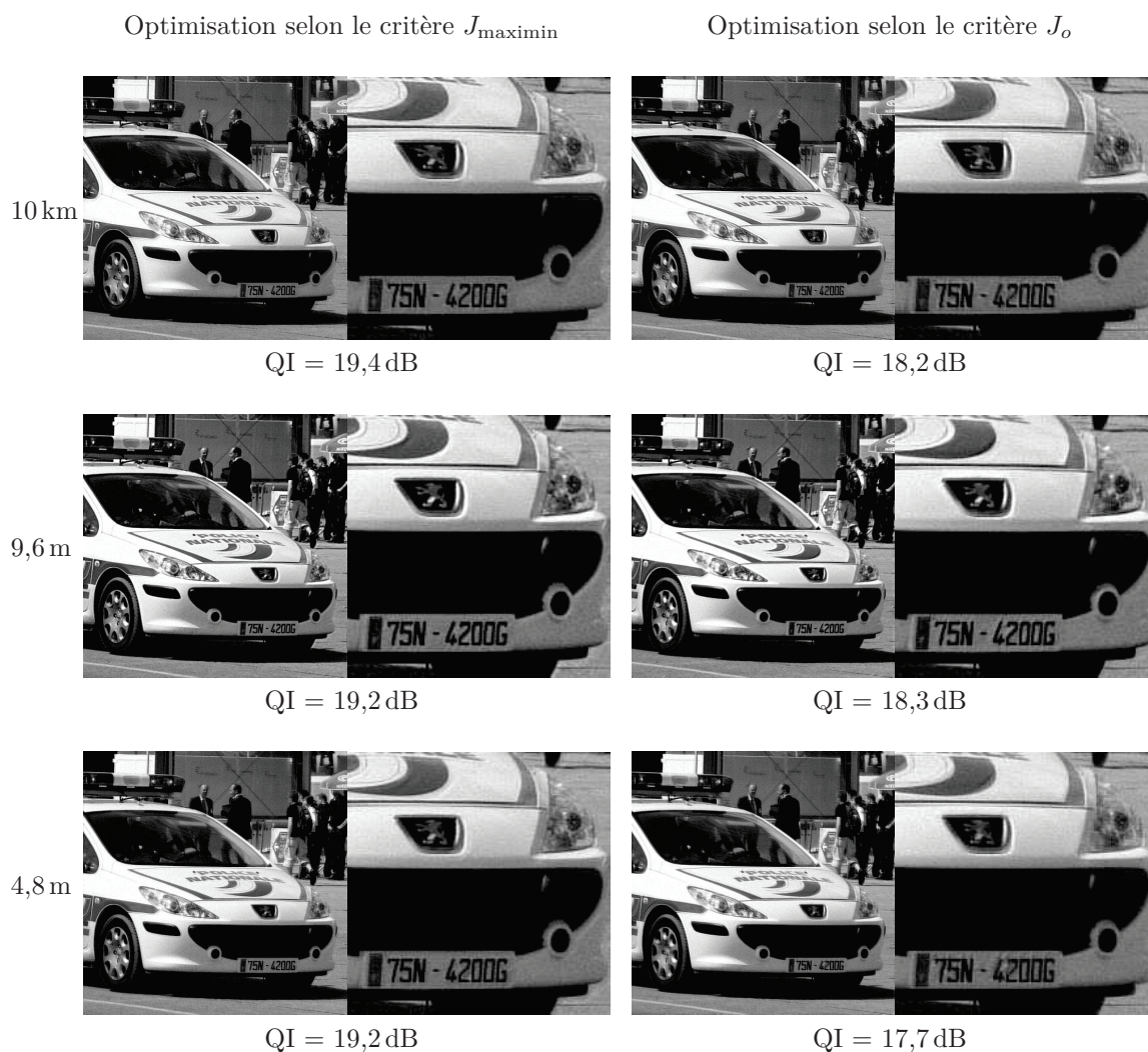
FIGURE 4.9 – Images de la voiture et QI associées pour le système hybride optimisé selon J_{\text{maximin}} (colonne 1) et J_o (colonne 2). Le détail de la plaque de la voiture est affiché pour visualiser l'augmentation du bruit après restauration et les artéfacts liés au masque polynomial.
