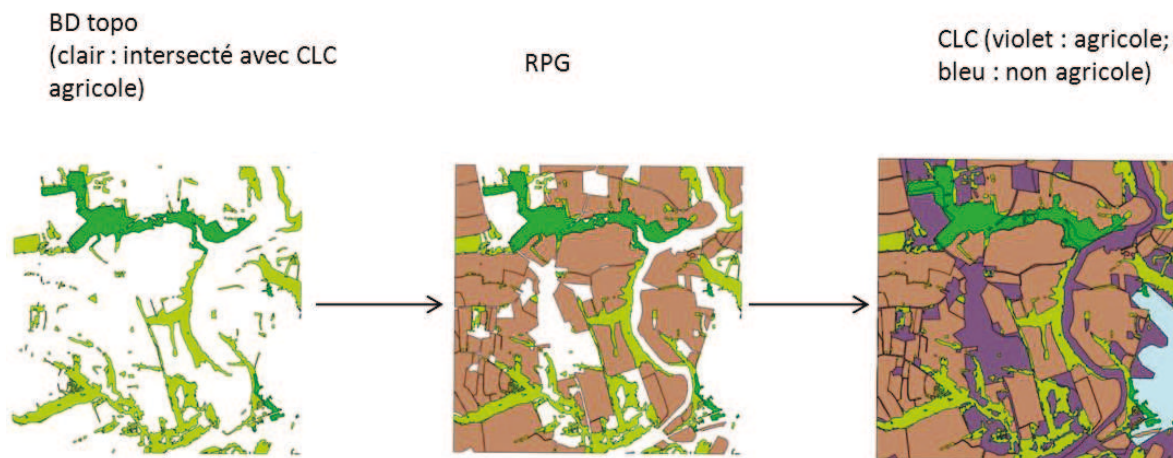
Figure 1: Procédures de superposition. La BD Topo est prioritaire sur le RPG (les îlots PAC voient donc leurs bordures rognées par les éléments arborés). CLC vient ensuite combler les vides.
