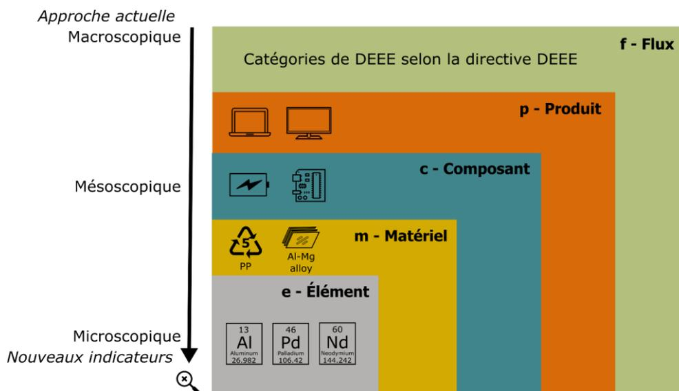
Figure 9.3. Niveaux de surveillance pour permettre une meilleure évaluation des performances de traitement.
