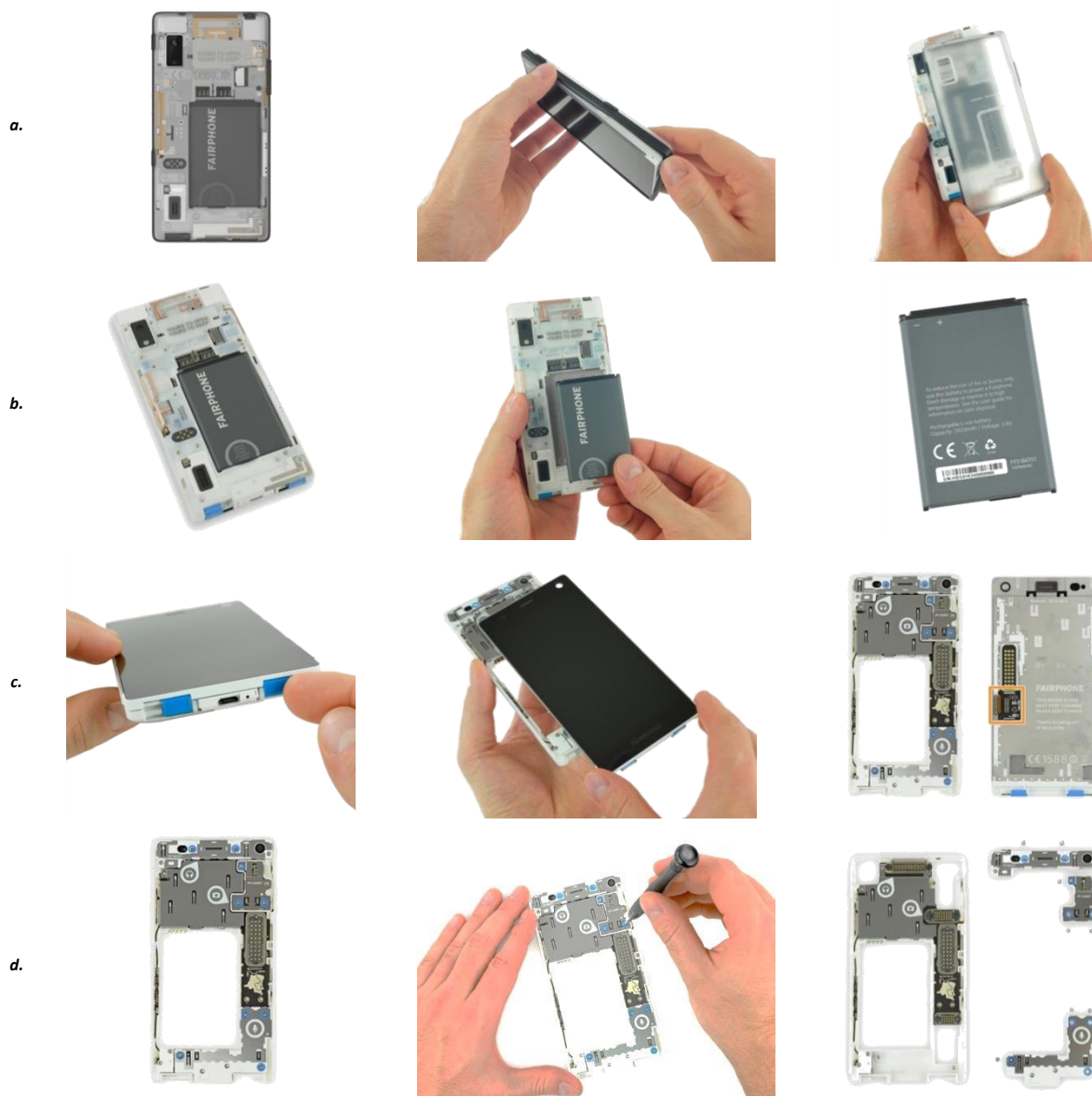
Figure 63. Démontage du Fairphone 2® (iFixit 2015)
