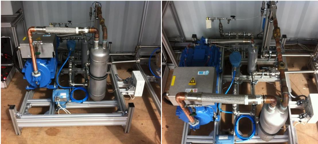
Figure 61 : Vue d'ensemble du block compresseur.
