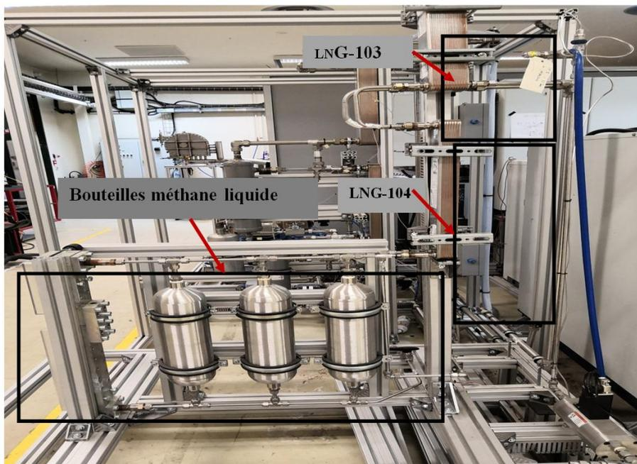
Figure 68 : Vue d'ensemble du bloc de liquéfaction du biométhane.
