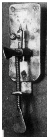
Figure 3.1 – Réplique du microscope développé par Antoni van Leeuwenhoek. Une lentille biconvexe placé entre deux plaques métalliques permet d'observer les échantillons placés sur le stylet que l'on peut déplacer grâce à une vis à crémaillère.
