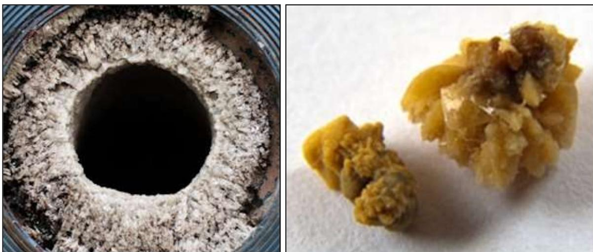
dépôt de struvite dans une canalisation
